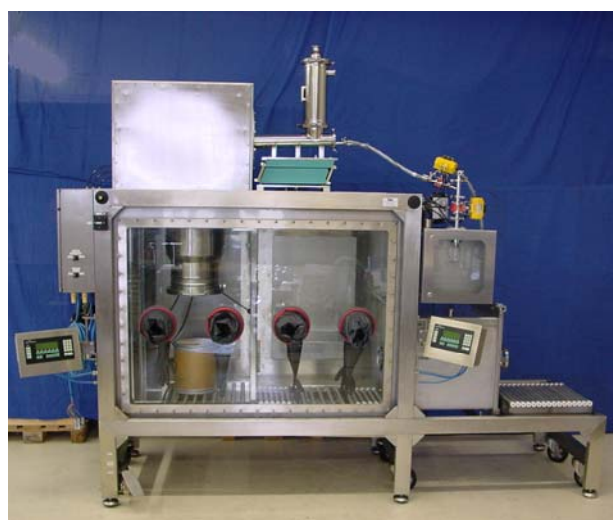
La boîte à gants mobile pour le remplissage sans poussière de fûts avec saches en continu.
